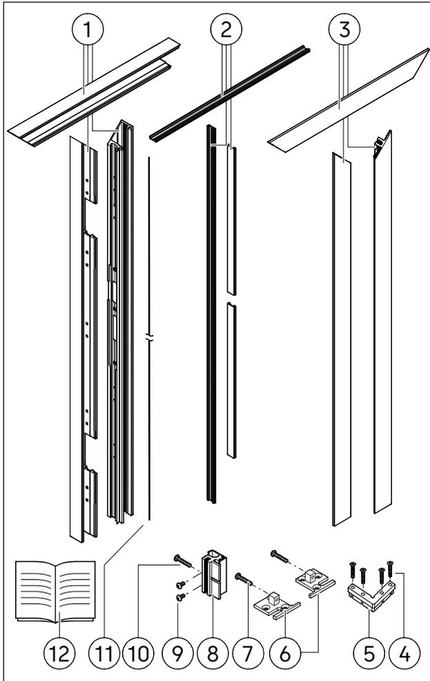
Abb. 5 Lieferumfang einer Zarge für Türen bis 80 kg
