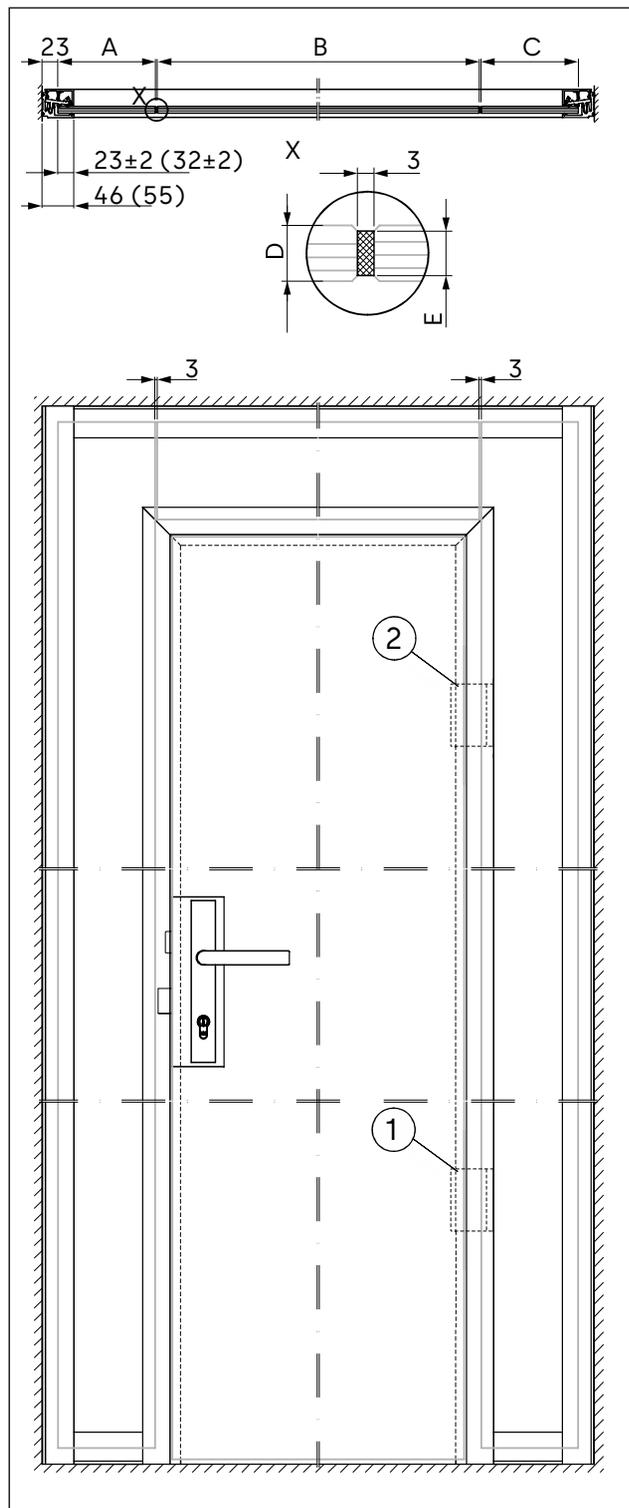
Abb. 50 Fugen zwischen Seitenteil und Oberlicht
