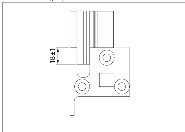
Abb. 14 Zargenpositionierer zur Bodenmontage am waagerechten Aufnahmeprofil
