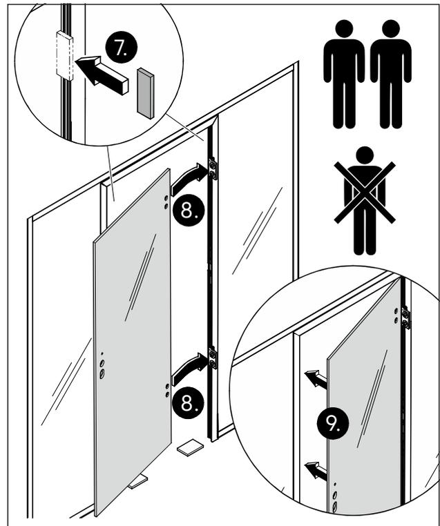
Abb. 42 Die Abstandhalter bei der Türmontage verwenden und die Glastür ausrichten.
