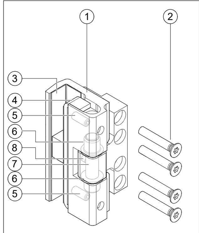
Abb. 6 Lieferumfang eines Türbands für Türen bis 80 kg
