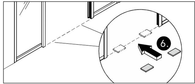
Abb. 41 Die Glastür auf die unteren Abstandhalter setzen.
