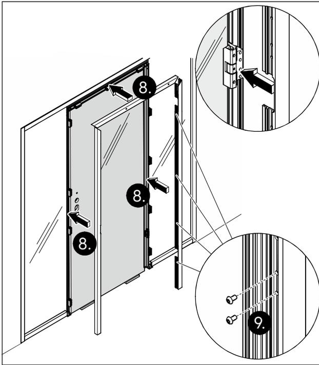
Abb. 49 Das Abdeckprofil montieren
