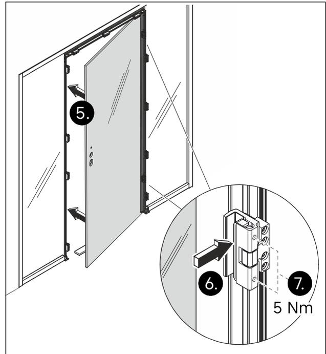
Abb. 48 Die Abstandshalter bei der Türmontage verwenden und die Glastür ausrichten.
