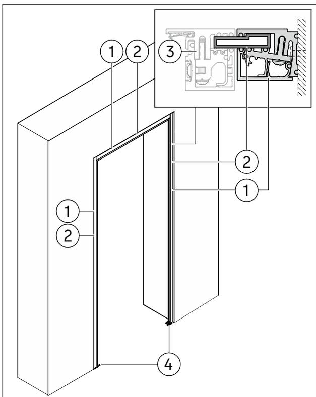
Abb. 12 Beispiel einer Einbausituation mit Aufnahmeprofil und Fixverglasungs-Adapterprofil
