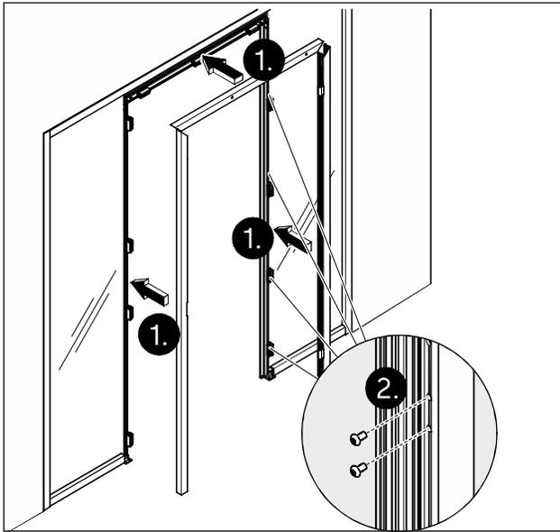
Abb. 39 Das Abdeckprofil montieren
