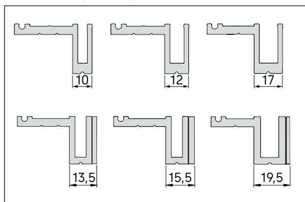
Abb. 15 Abmessungen der Zargen-Adapterprofile
