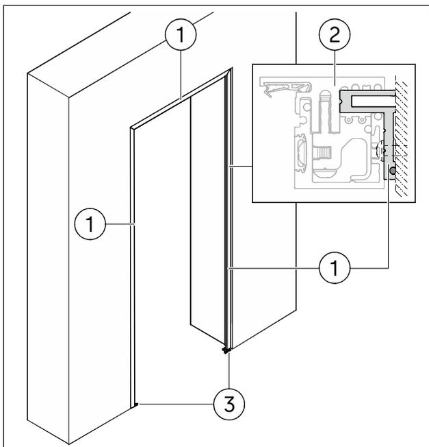
Abb. 11 Beispiel einer Einbausituation mit direkter Wandanbindung ohne Aufnahmeprofil
