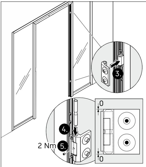
Abb. 40 Die Türbänder montieren
