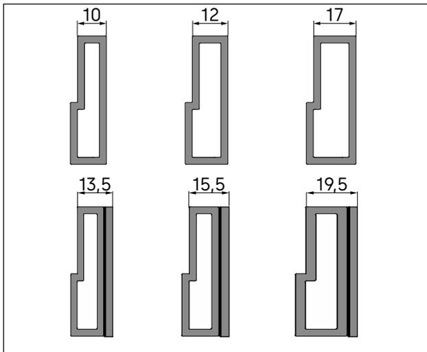
Abb. 16 Abmessungen der Fixverglasungs-Adapterprofile
