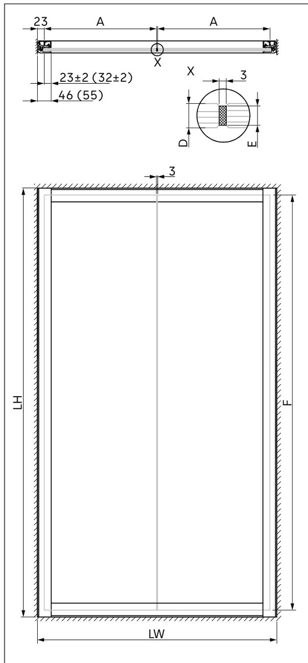
Abb. 51 Fugen zwischen Seitenteil und Seitenteil.
