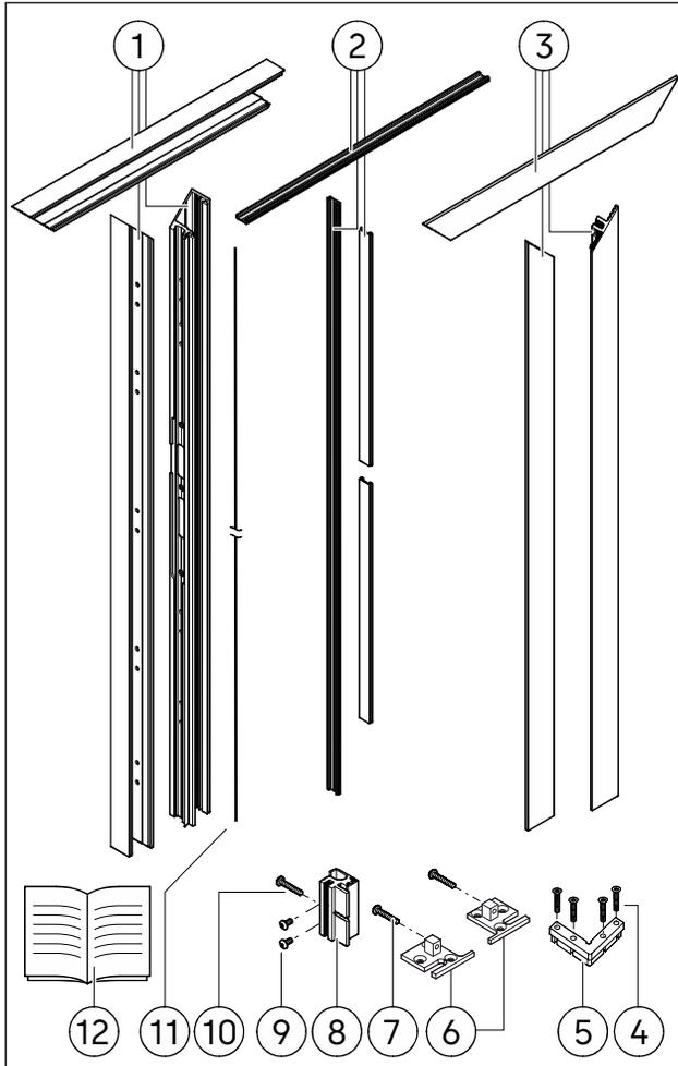
Abb. 3 Lieferumfang einer Zarge für Türen bis 130 kg
