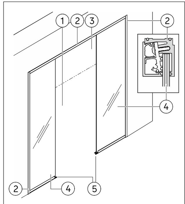
Abb. 10 Einbausituation zwischen Glaselementen und mit vorgesehenem Oberlicht als Beispiel
