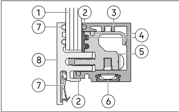
Abb. 8 Beispiel einer montierten Zarge
