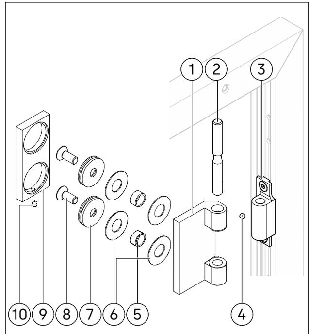
Abb. 4 Lieferumfang eines Türbands für Türen bis 130 kg
