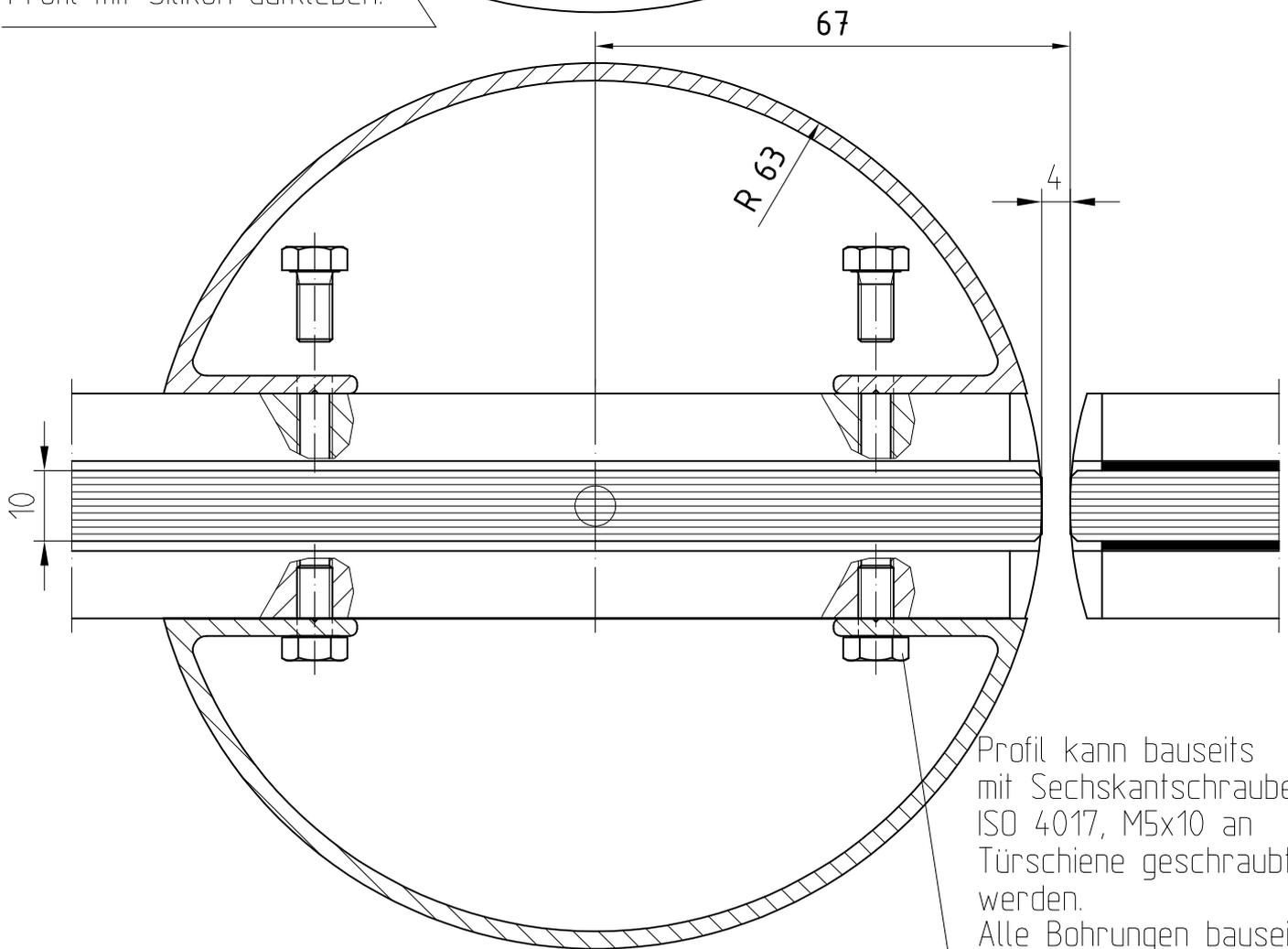
Profil kann bauseits mit Sechskantschraube ISO 4017, M5x10 an Türschiene geschraubt werden. Alle Bohrungen bauseits
