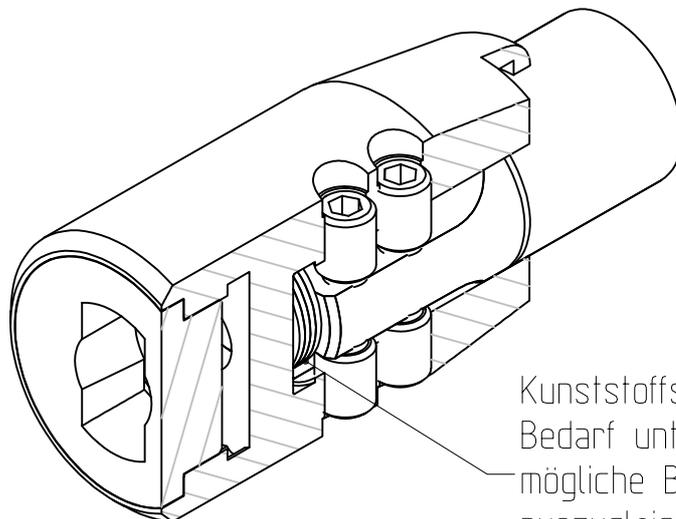
Kunststoffscheiben bei Bedarf unterlegen, um mögliche Bautoleranzen auszugleichen
